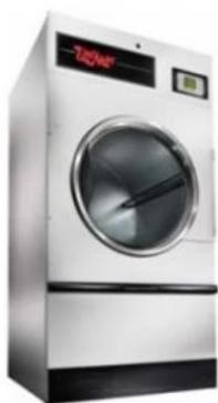
Машина сушильная серии UU, мод. UU055ERQM1S2W01, 876x1362x1695мм, 27750Вт, 380В/3ф, загрузка 24,5 кг, система подогрева: электронагреватель. Тип управления: Dual Digital Timer, позволяет выбрать температуру, время подогрева и охлаждения. Объем барабана: 491л. Диаметр/глубина барабана: 838/889. Корпус из окрашенной стали. Барабан из нержавеющей стали. Реверс барабана. Обратный отчет времени до окончания цикла. Повтор цикла сушки одним касанием. Самоочищающийся фильтр для удаления ворса.
